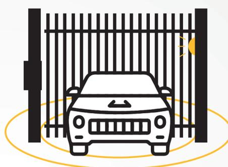
Através de sensores, o portão fechará automaticamente após a passagem, desconsiderando a temporização.
